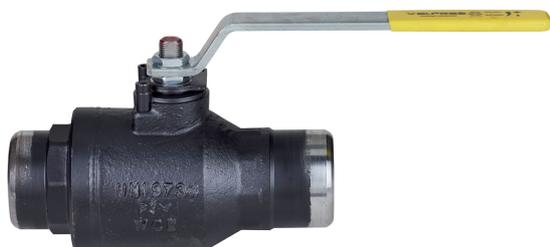
Vanne à boisseau sphérique à enterrer en acier ASTM A105, soudure en bout, selon la norme UNI 9734 et EN 13774, pour sectionnement du gaz naturel, avec levier.
